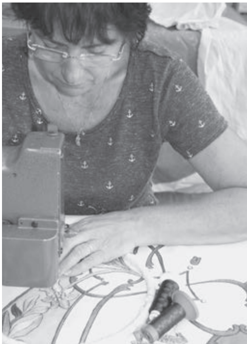
Abb.: 4 Behutsame händische Ausbesserungsarbeit mit der Plattstichmaschine
