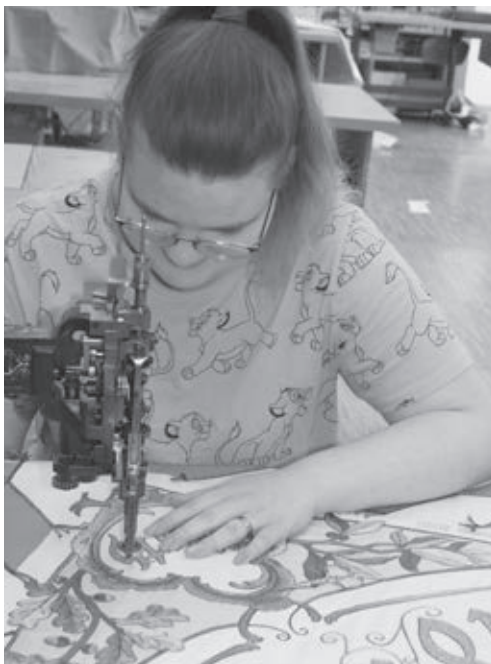
Abb.: 3 Bereits über 100 Jahre alt ist die Kurbel- und Kettstichmaschine von Cornely, mit der hier gearbeitet wird.
